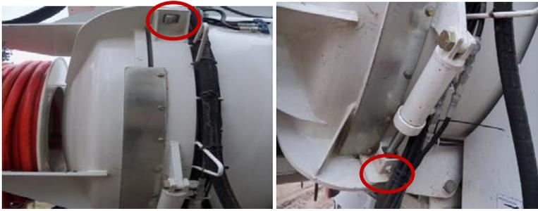
Una vez vaciado el Tanque y retiradas las trabas se prosigue con el siguiente paso, hay que abrir la puerta del tanque, para ello primero hay que retirar hacia un lado la manguera de aspiración, con el control remoto se levanta y se desplaza hacia un costado luego accionamos de forma suave con la palanca del medio y la puerta se abrirá lentamente hasta llegar a su tope. Ver gráfico
