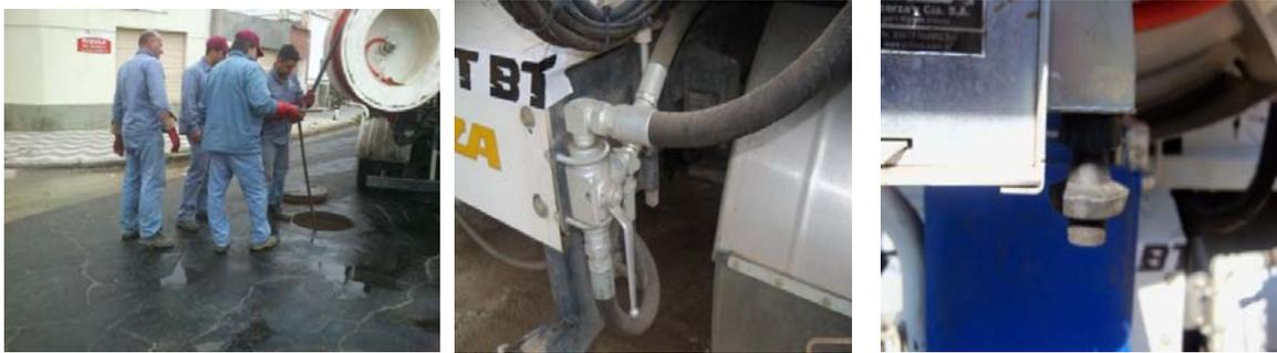
Para operar con el sistema de aspiración no es necesario tener acoplada la bomba de presión (**Sexta marcha en alta**), si es importante que el camión este en marcha siempre, situado el equipo junto a la BR se pone en marcha el motor auxiliar, luego con el control se ubica la manguera en posición y se acelera el equipo hasta que se percibe la subción que provoca el accionar de la turbina, trabajando la manguera a centímetros del sólido se comienza a limpiar la cámara BR.
