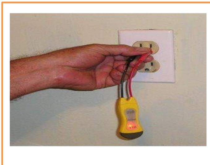
En la siguiente figura se usa un multímetro como comprobador de voltaje. En este caso no sólo sabemos si hay o no voltaje, sino también su valor exacto.
