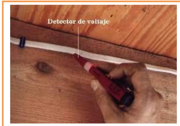
Es un dispositivo con pilas, así que es recomendable verificar su funcionamiento con cierta frecuencia usando cables que usted sepa que están energizados, para cambiar las pilas antes de que el detector falle por falta de alimentación interna.
